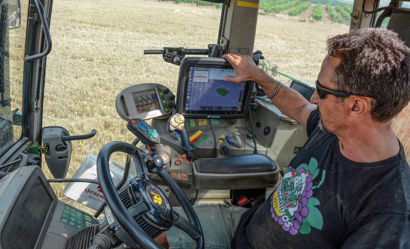
Juan Carlos Sáinz muestra en el ordenador del tractor autoguiado el avance del pulverizador (en verde) y las líneas guía (en rojo) de la parcela.
