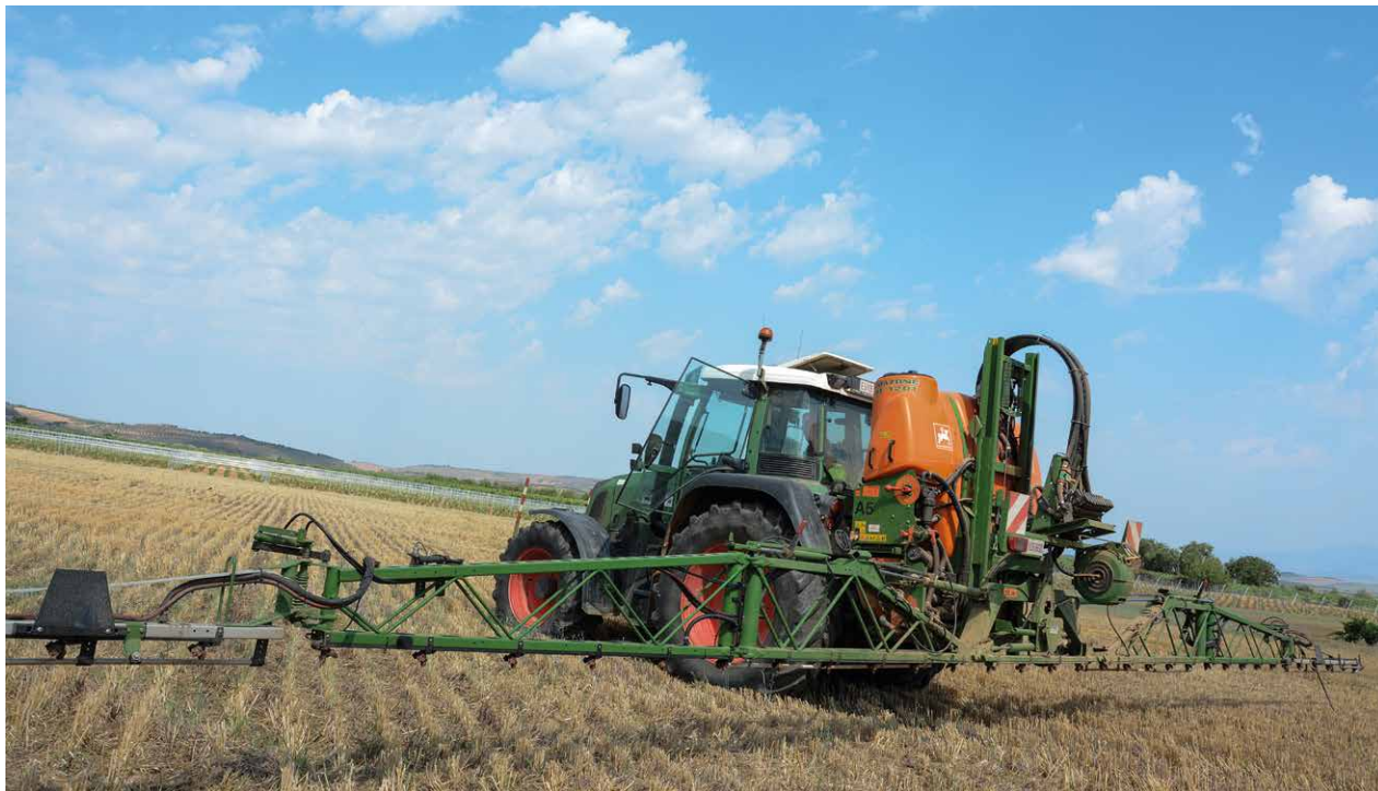
Tractor con autoguiado y apero con Isobus que permite una mayor precisión en la aplicación de fitosanitarios.
